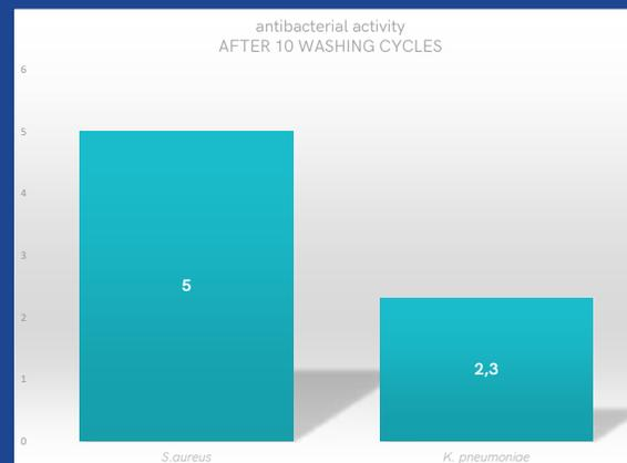
La propriété antibactérienne a été aussi apportée au textile grâce au processus de diffusion. Cette méthode permet aux molécules de se fixer au cœur de la fibre et non pas uniquement en surface de celle-ci. Plusieurs principes actifs ont été testés sur des échantillons de polyester (PET), notamment le thymol et l'ortho-vanilline.
