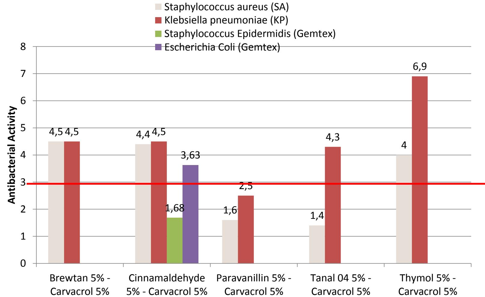
Essais antibactériens réalisés par CENTEXBEL / Antibacterial tests performed by CENTEXBEL
